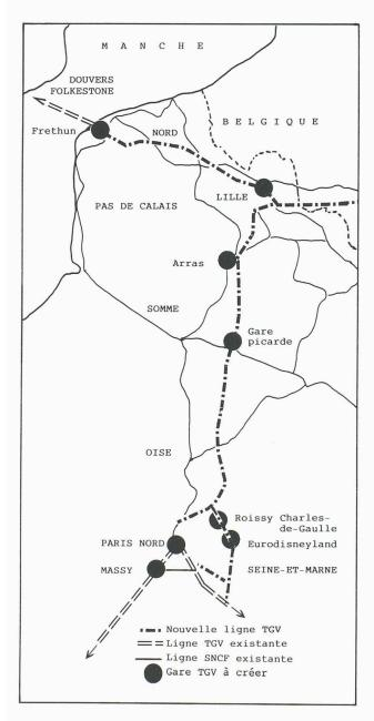
Fig. 1. - Implantation du TGV Nord et de l'interconnexion.
