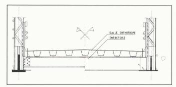
Fig. 7. - Tablier métallique.
