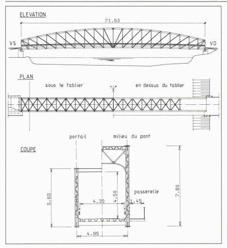
Fig. 3. - Système du pont métallique triangulé.
