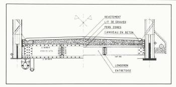
Fig. 5. - Tablier avant la rénovation.
