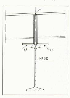
Fig. 9. – Fixation du tablier métallique sur les entretoises existantes.
