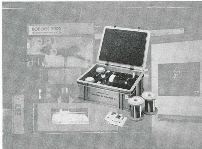
Le Micro-Cut 1000, un équipement optionnel pour la réalisation de micro-usinage sur les Robofil de la série 1000 de Charmilles Technologies.
