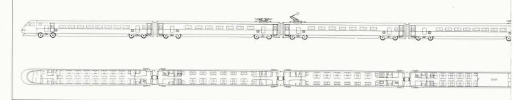
Le Pendolino vu par l'industrie ferroviaire suisse : 8 voitures dont 4 motrices, 211 m de long, 410 places assises, 400 tonnes, 200 km/h. Partenaires : Schindler Waggon, Altenrhein ; Fiat-Ferroviaria, Savigliano (Italie) ; ABB Asea Brown Boveri, Zurich ; Ateliers de constructions mécaniques de Vevey SA; SIG Société industrielle suisse, Neuhausen.
