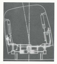
Représentation schématique du système actif d'inclinaison.
