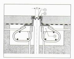
Selon le mode de construction, l'amplitude de ces mouvements peut atteindre plusieurs millimètres. Les raccordements de chaussée sont donc soumis à une véritable épreuve de rupture.
