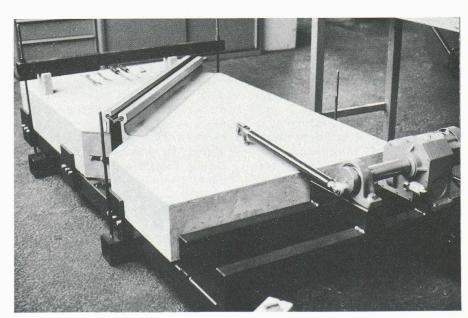
Fig. 4. – TENSA-Grip GL50 avec gouttière de contrôle et tôles d'enveloppe du joint, incorporé au corps d'essai sous un angle de 450 par rapport au sens de déplacement (LFEM). La partie mobile a été déplacée lentement 12 000 fois sur une course de +25 mm, dont 1000 fois dans une chambre frigorifique à -20°C.
