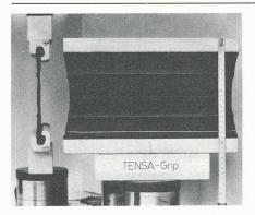
Fig. 3. – Essai d'arrachement: la fixation du profilé en élastomère résiste encore après un déplacement du joint plus que doublé. (Photo LFEM.)
