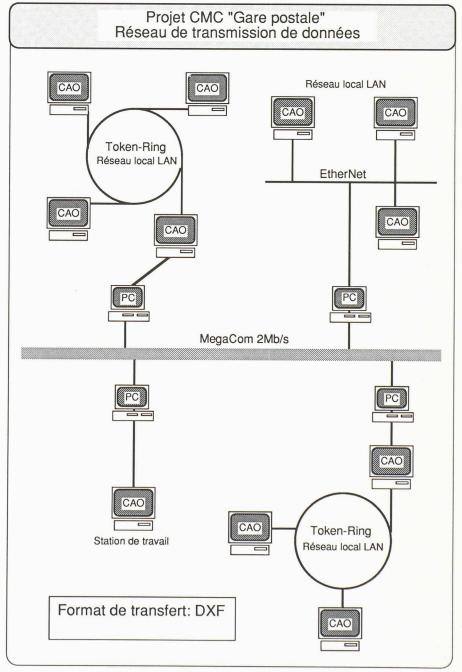
Fig. 7. - Gare postale de Bâle: réseau de transmission des données.
