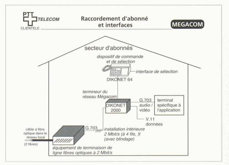
Fig. 6. - Eléments du système MEGACOM.
