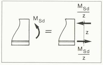
Fig. 3. - Section sollicitée par Msd.
