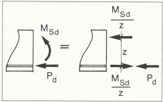
Fig. 2. - Section sollicitée par M<sub>Sd</sub> et P<sub>d</sub>.
