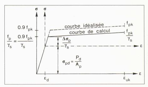
Fig. 1. – Déplacement de l'origine du diagramme  $\sigma$ - $\epsilon$  pour l'acier de précontrainte de la valeur  $\epsilon_d$  correspondant à  $\sigma_{pd} = \frac{P_d}{\Delta}$ .
