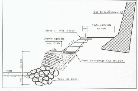
Fig. 3. – Coupe type du perré provisoire dans la zone de la carrière de Güetli à Gurtnellen.
