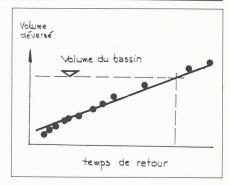
Fig. 16. – Dimensionnement d'un bassin d'eaux pluviales.
