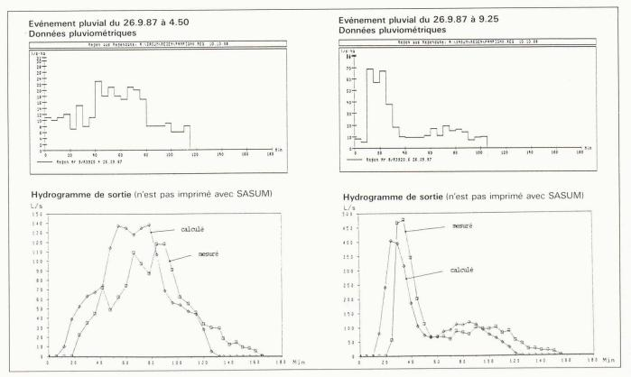
Fig. 14. - Exemples d'hydrogrammes mesurés et calculés.
