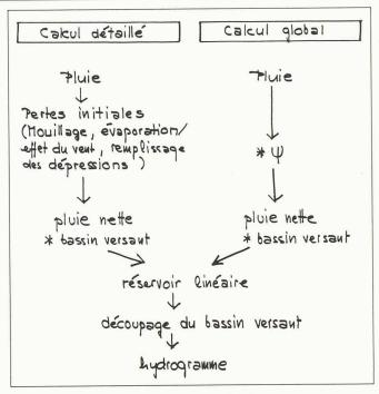
Fig. 13. - Modèle d'écoulement superficiel.
