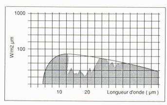
Fig. 6. - Spectre de la radiation terrestre, ciel couvert [1].
