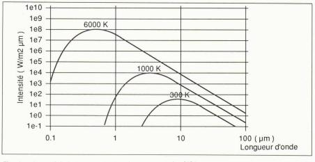
Fig. 1. – Intensité du rayonnement des corps noirs [1] 1.
