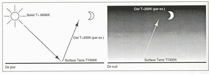
Fig. 8. - Combinaison radiation solaire et infra-rouge.
