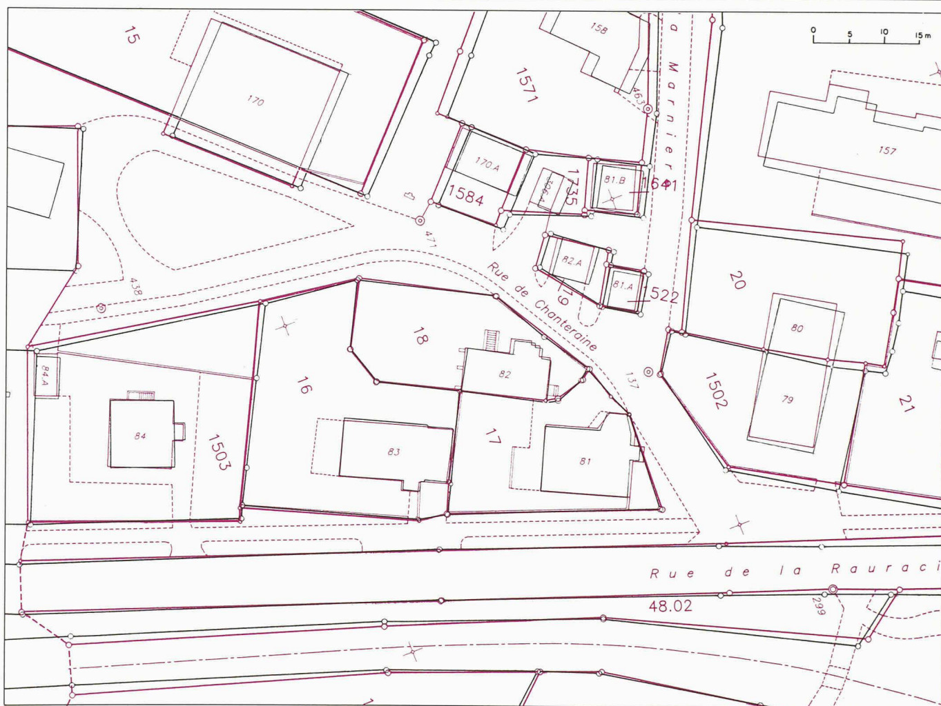
Fig. 4. - Le Noirmont: superposition d'un extrait du plan cadastral de 1938 (en noir) et de celui de 1991 (en rouge). Le plan de 1938 est une copie du plan de 1910, qui est lui-même une copie du plan original de 1853.
