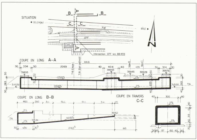
Fig. 6. - Passage inférieur vers la halte CFF.
