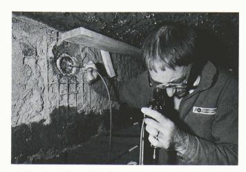
Fig. 6. - Auscultation à l'endoscope.
