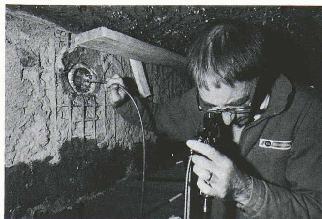
Fig. 6. – Auscultation à l'endoscope.
