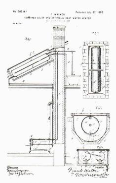
Fig. 2. - Copie du brevet de chauffe-eau solaire déposé par Frank Walter en 1902 à Los Angeles.
