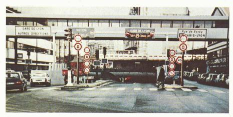
Fig. 4. - Une signalisation pléthorique distrait le conducteur.
