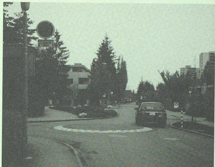
En ce qui concerne les «ralentisseurs» (les rehaussements de chaussée, les décrochements verticaux et dans une moindre mesure les rétrécissements), l'expérience montre que les réhaussements sont de loin la mesure la plus efficace et, contrairement aux décrochements horizontaux, ils ne détruisent pas le caractère traditionnel de l'espace rue. En revanche ils sont assez mal acceptés par les automobilistes.
