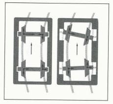
Essieux fixes dans un bogie (à gauche) et s'orientant selon le rayon de la courbe (à droite). (ABB.)
