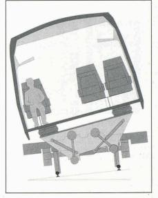
Schéma du dispositif d'inclinaison de X2000. (ABB.)
