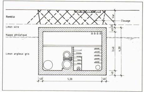
Fig. 11. – Tronçon réalisé en tunnel, profil type.
