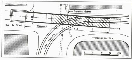
Fig. 10. - Tronçon réalisé en tunnel, vue en plan.
