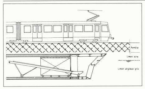
Fig. 12. - Tronçon réalisé en tunnel, coupe longitudinale.
