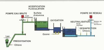
Fig. 1. - Schéma du traitement de l'eau du lac.
