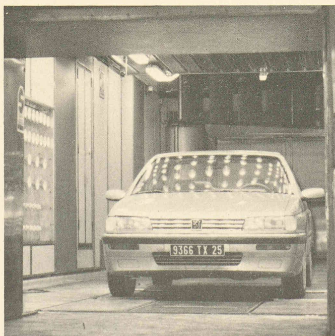
Dans le centre technique de Peugeot à Belchamp, des essais de moteur et de carrosserie sont effectués dans la chambre aéroclimatique. Des lampes simulent le rayonnement solaire.
