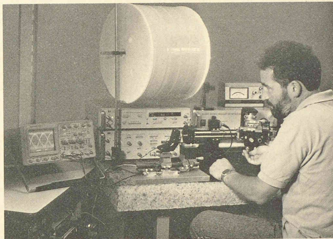
Transmission à 2,61 \mu\text{m} et 140 Mb/s au travers d'une fibre optique monomode en verres fluorés.
