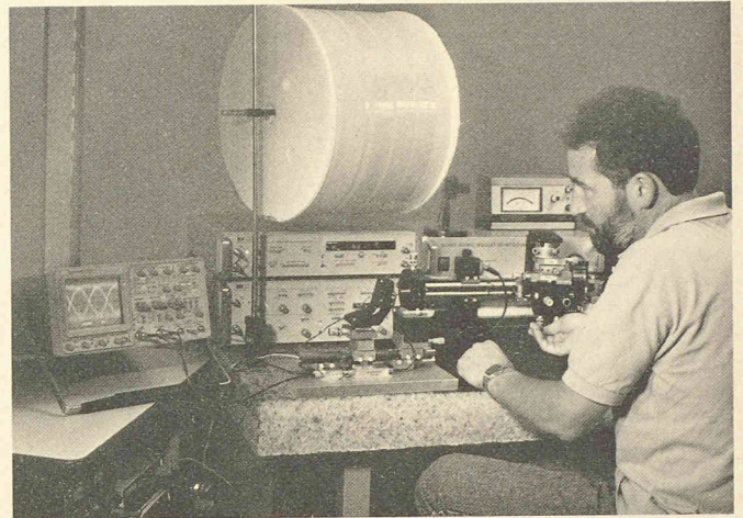
Transmission à 2,61 µm et 140 Mb/s au travers d'une fibre optique monomode en verres fluorés.
