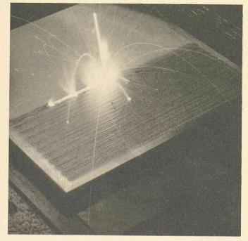
Mince couche d'alliage précieux, obtenue par laser, offrant une exceptionnelle résistance à l'usure. (Photo Sulzer.)
