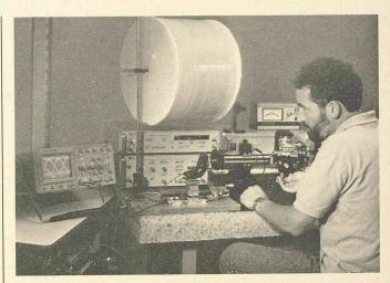
Transmission à 2,61 µm et 140 Mb/s au travers d'une fibre optique monomode en verres fluorés.
