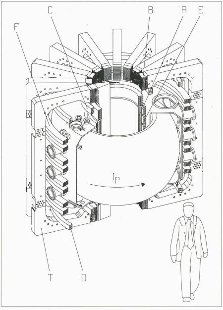
Fig. 4. – Vue éclatée du tokamak TCV (tokamak à configuration variable). Le champ magnétique vertical ou polaire peut être divisé en deux parties : les bobines A-B-C-D engendrent par induction le courant dans le plasma, les bobines E et F agissent sur la position du plasma et sur la forme de sa section. Les résistances mécaniques des bobines et de leurs fixations sont suffisantes pour supporter des forces verticales allant pour la bobine C jusqu'à 100 t et pour F jusqu'à 200 t.
