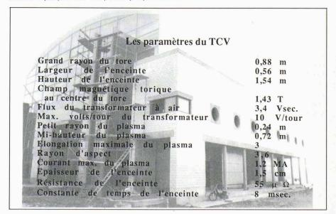
Fig. 5. - Les paramètres du TCV sur fond de la halle en cours de construction.
