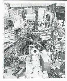
Fig. 3. – Le TCA (tokamak pour l'étude du chauffage par ondes d'Alfvèn) du CRPP. Le laser infrarouge lointain (IRL) développé au CRPP a permis de démontrer en automne 1988 la faisabilité de la mesure de la température des ions du plasma du TCA par diffusion Thomson collective. Le laser à eau lourde (385/ $\mu$ m) fournit 2 MW et est déclenché par un laser à  $C_2$  (9,26  $\mu$ m) de 1000 MW, pendant 1  $\mu$ s.
