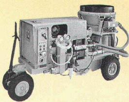
de consolider des couches rocheuses sèches ou aquifères dans la construction de tunnels. Sans modification, la machine peut passer en quelques minutes de la voie humide à la voie sèche ou vice versa.
