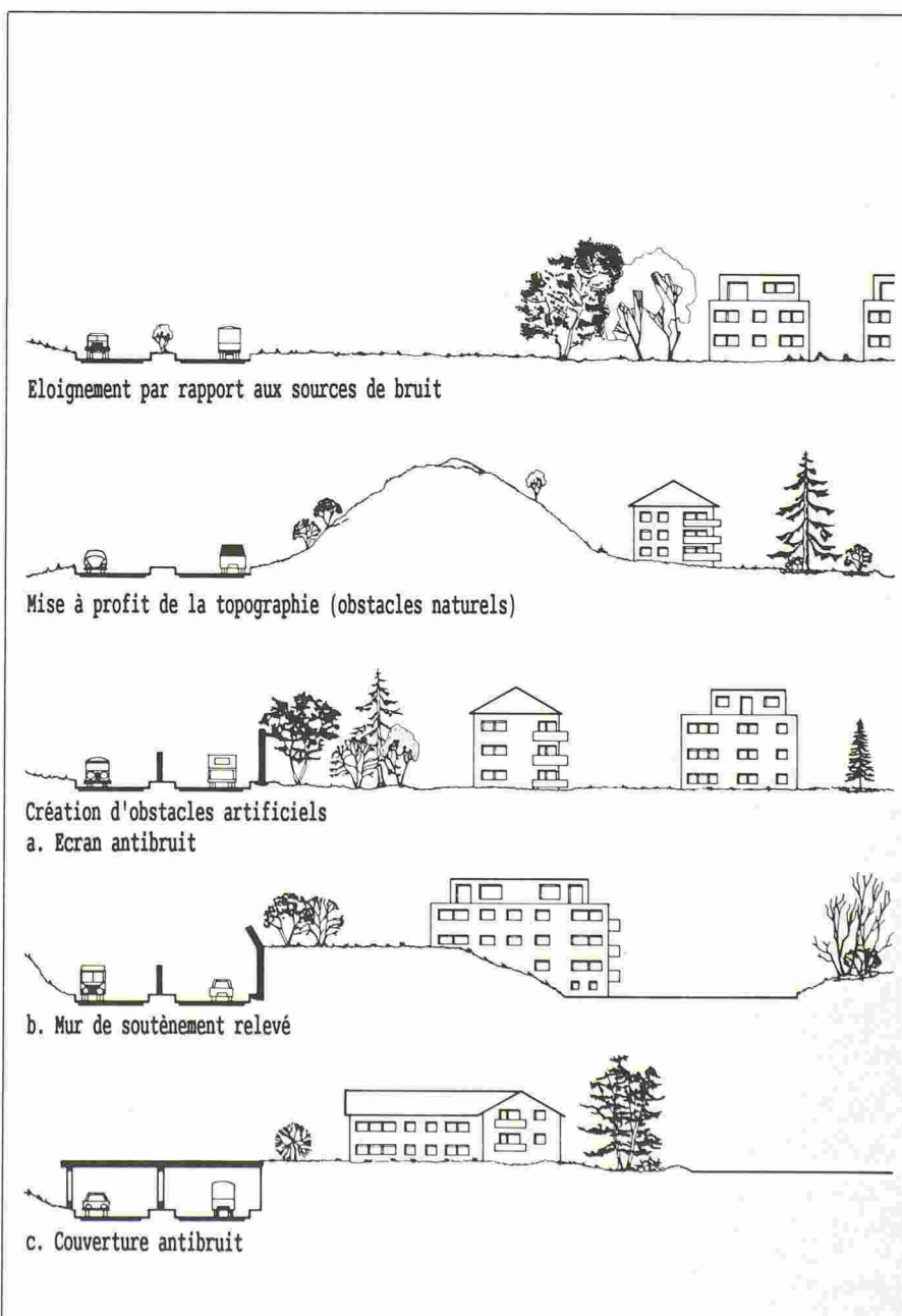
Fig. 7. - Principaux moyens d'isolation contre le bruit extérieur.
