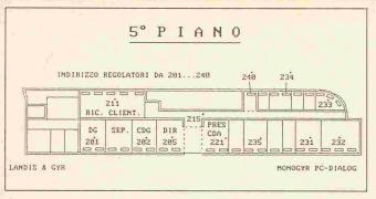
Fig. 3. - Visualisation sur écran du local sélectionné.
