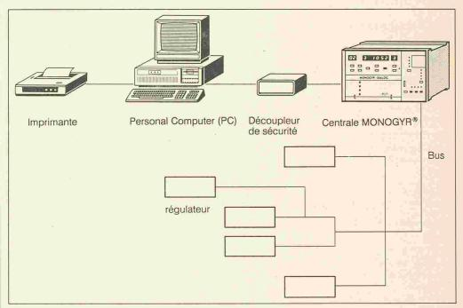
Fig. 1. - Structure du matériel pour progiciel Monogyr PC Dialog.
