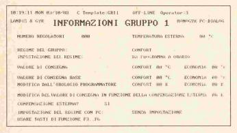
Fig. 5. – Visualisation des données et possibilités d'intervention au niveau d'un groupe.
