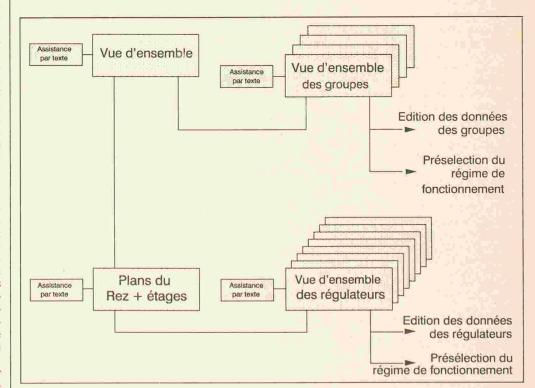
teur donné, il lui suffit d'activer | Fig. 2. - Structure du progiciel Monogyr PC Dialog spécifique à une installation donnée.
