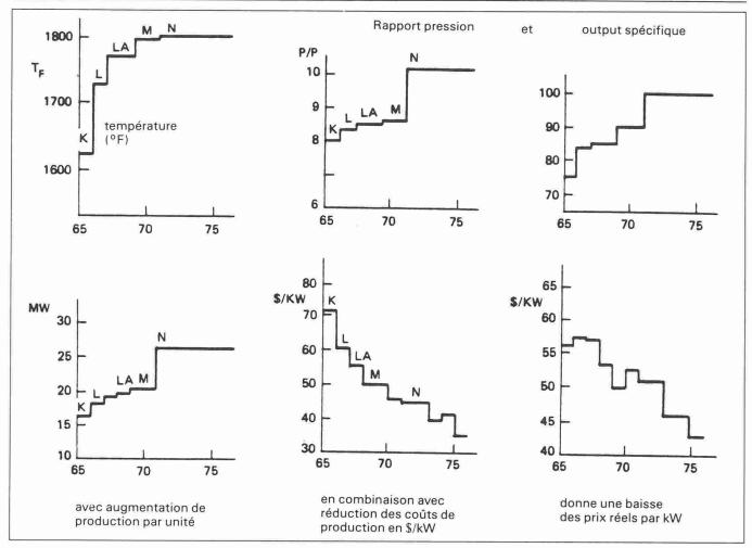
Fig. 9. - Histoire technologique d'une turbine à gaz (MS 5001).
