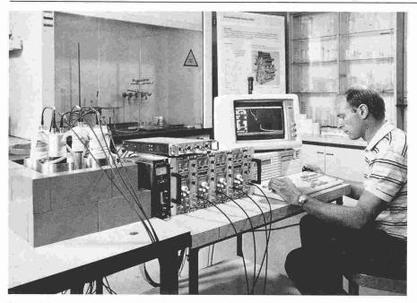
Dispositif de mesure pour la détermination du taux d'enlèvement par activation de couches minces. (Photo Sulzer.)
