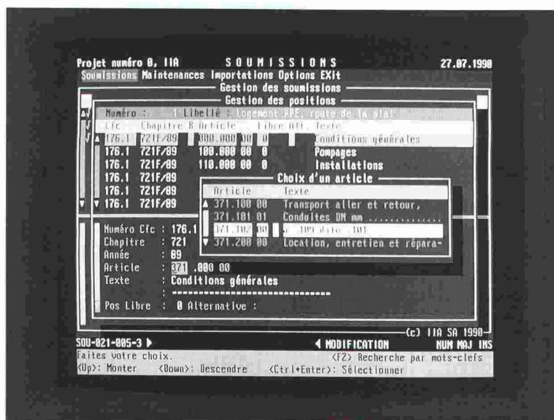
ArCan 2000 fonctionne sur tous les micro-ordinateurs compatibles IBM AT avec 640 K de mémoire, un disque dur de 40 MB au moins et DOS 3.3. Il est en cours d'homologation par le CRB.
