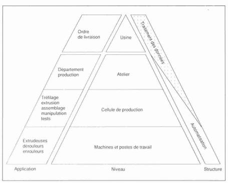
Fig. 1. - Configuration d'un système CIM pour la fabrication de câbles.
