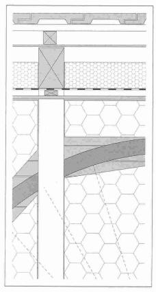
Défaut de la couche d'isolation thermique dans les plans à géométrie non orthogonale:
