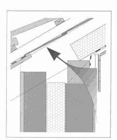
Défaut dans les zones de transition entre éléments de construction – par exemple façade et toit à pans inclinés – à proximité de la gouttière:
