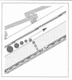
L'air extérieur froid pénêtre par le vide d'aération dans la zone située entre la couche d'isolation thermique et la barrière de vapeur (ou pare-vapeur). La couche d'isolation est parcourue par l'air froid, le pouvoir isolant est diminué et le bâtiment refroidi:
