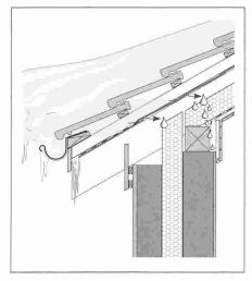
Eau de refoulement dans la zone de la gouttière:
