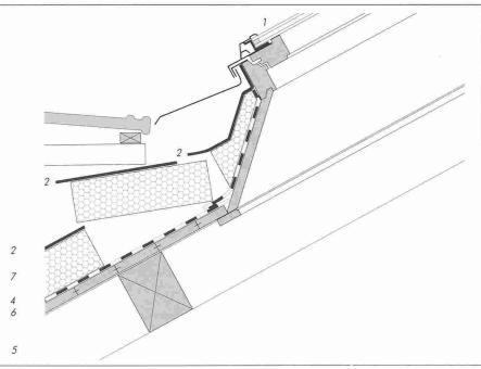
La fenêtre de toiture Sarna/Velux est simplement raccordée en surface, sur le chantier, aux couches correspondantes du toit à pans inclinés avec isolation thermique.
