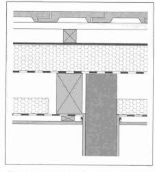
Pose d'une couche d'isolation thermique supplémentaire dans une structure de toit à pans semi-ventilés, par exemple avec un SarnaPanel standard. Les ponts thermiques, notamment pour les murs intérieurs traversants, peuvent être éliminés.
