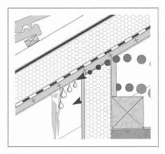
Zone de la gouttière pour une structure de toit à pans semi-ventilés:
