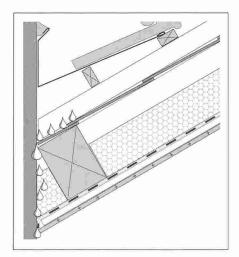
Infiltrations sur des éléments de construction qui remontent et traversent le toit à pans inclinés:
