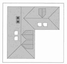
L'aération des combles à géométrie compliquée, avec arêtes, noues et superstructures, n'est pas assurée.
