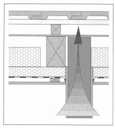
Pose, côté interne, d'une couche d'isolation thermique supplémentaire (l'efficacité, au niveau de la technique thermique et de la diffusion de vapeur, doit être vérifiée dans chaque cas particulier). Les ponts thermiques, notamment pour les murs intérieurs traversants, ne peuvent pas être éliminés
