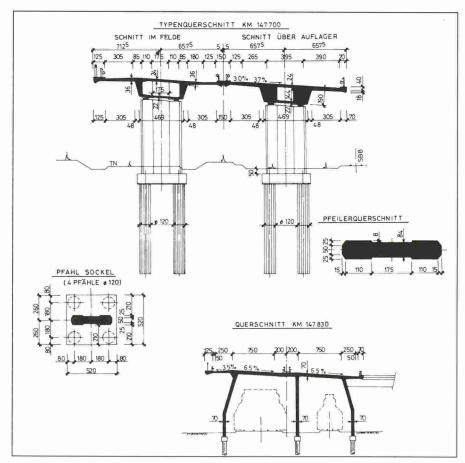
Chaque pont repose sur des piles rectangulaires. Le passage des voies ferrées s'effectue en galerie.
