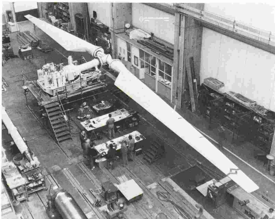
L'hélice de 32 m de diamètre d'une éolienne «Medit» dans les ateliers de De Pretto-Escher Wyss à Schio. Une éolienne de ce type tourne déjà en Sardaigne.
