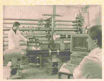
Dans le centre de mesure et de calibrage de Degussa AG, on vérifie le respect des caractéristiques spécifiées pour les appareils Deguflow destinés à la détection directe du débit massique de gaz.
