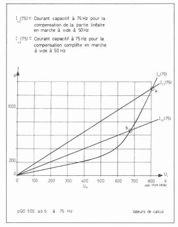
Fig. 7. - Caractéristiques à vide d'une génératrice asynchrone.
