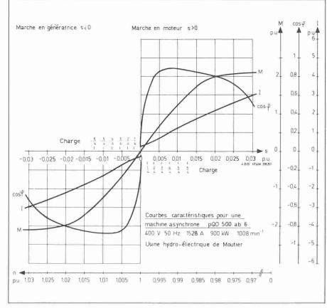
Fig. 2. – Courbe de performance entre la vitesse synchrone (s=0, n=1 pu=1000 min $^{-1}$ ) et le glissement ( $s_k=\pm 0.031$  pu). Le domaine utilisable en permanence se situe entre la marche à vide et la charge nominale (charge  $^{4}$ /4). Les  $^{5}$ /4 et  $^{6}$ /4 de la charge ne peuvent être utilisés que durant une courte période.
