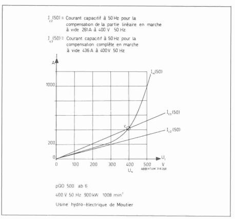
Fig. 6. - Caractéristiques à vide d'une génératrice asynchrone.
