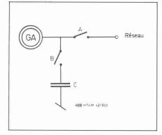
Fig. 5. – Compensation par condensateur pour une machine asynchrone.
