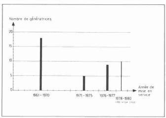
Fig. 16. – Nombre de génératrices asynchrones en tonction de l'année de mise en service en Suisse de 1961 à 1980.
