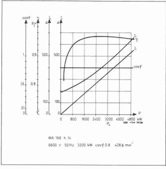
Fig. 21. - Caractéristiques d'une génératrice asynchrone.
