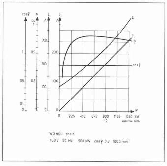
Fig. 19. - Caractéristiques d'une génératrice asynchrone.
