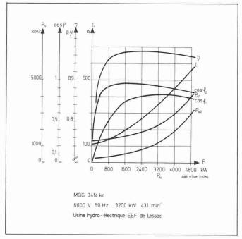
Fig. 20. - Caractéristiques d'une génératrice asynchrone.
