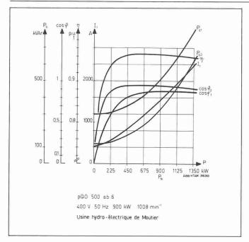
Fig. 18. - Caractéristiques d'une génératrice asynchrone.
