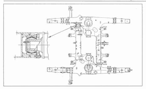
Fig. 7. - Châssis du bogie.
