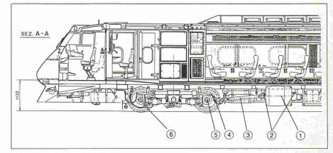
Fig. 3. - Liaison moteur-bogie-caisse.
