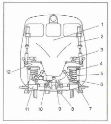
Fig. 5. – Schéma de commande du système de rotation de la caisse et de la suspension latérale active.
