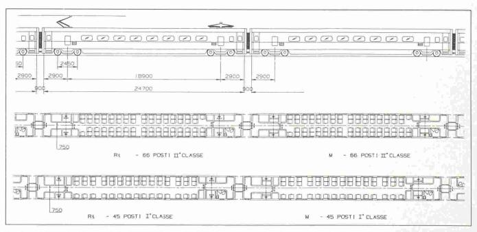
Fig. 8. - Unité de traction de l'offre FIAT/ABB pour les CFF. Aménagement en 2e classe (en haut) et en 1re classe (en bas).
