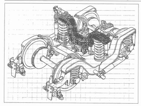
Fig. 4. - Le bogie du Pendolino ETR 450.
