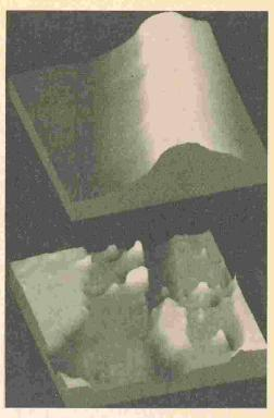
Obtenues simultanément par microscope pour forces magnétiques, les deux images de gauche montrent, en bas, la topographie de la piste magnétique d'une nouvelle sorte de disques de stockage informatique et, en dessus, les forces magnétiques qui s'y exercent.
