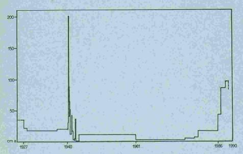
Fig. 3 Déplacements de la partie orientale ; les lignes horizontales indiquent les périodes sans mesures.
