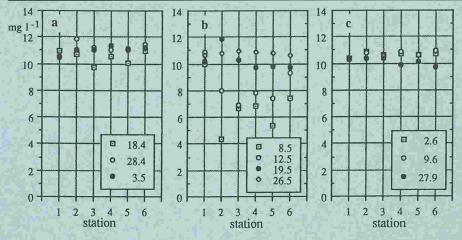
Fig. 2 Concentrations d'oxygène avant (a), pendant (b) et après la purge (c).
