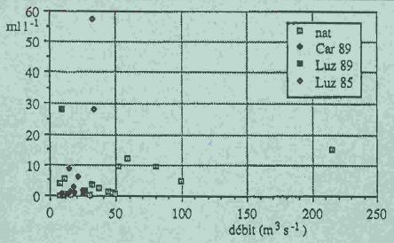
FIG. 7 Valeurs maximales de la concentration des substances sédimentables en ml par litre (moyenne journalière) en fonction des débits moyens journaliers corréspondents pow des évènements natwels (nat) et les pwges du Carassina (Car 89, ce travail), et les pwges de la retenue du Luzzone (mesures effectuées à la station S) aux années 1985 (Luz 85) et 1989 (Luz 89).
