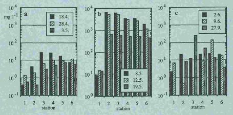
Fig. 3 Concentration des sédiments en suspension avant (a), pendant (b) et après la purge (c).
