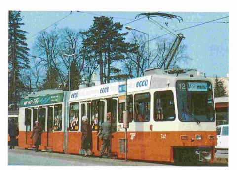
Fig. 5. – Tramway articulé à plancher surbaisse des Ateliers de Constructions Mécaniques de Vevey pour les Transports publics genevois.
