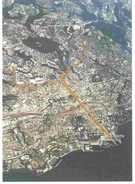
Fig. 7. – Proposition de prolongement du métro Ouchy-gare CFF-Flon vers la place du Tunnel avec deux extensions vers le nord-est et vers le nord-ouest. La ville de Lausanne qui s'étage du bord du lac (altitude 375 m) à l'autoroute de contournement (altitude 650 m) requiert des technologies de transport particulières pour vaincre des déclivités atteignant 11%.
