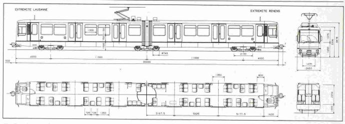
Fig. 1. - Automotrice articulée Bem 4/6: plan général.
