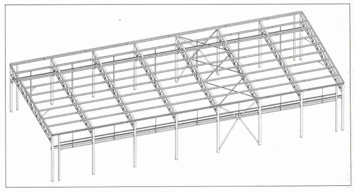
Fig. 3. – Dépôt-atelier: charpente métallique de la halle d'entretien.
