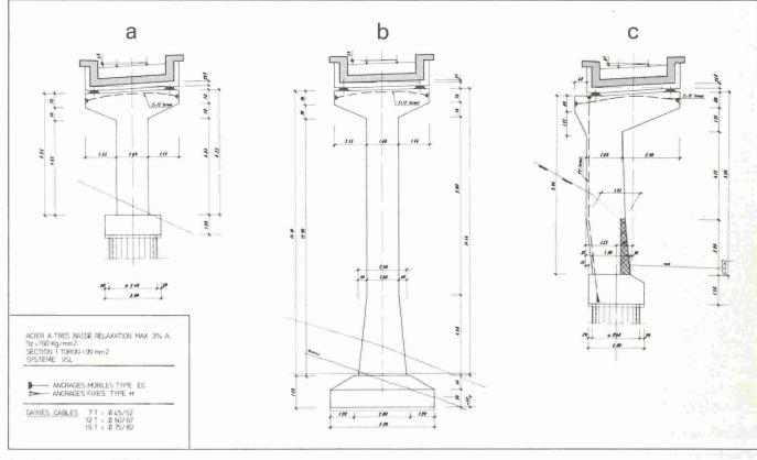
Fig. 2. - Pont de l'EPSIC; a: pile courante fondée sur puits; b: pile Nº 5 fondée sur semelle; c: pile Nº 2 à forte asymétrie.
