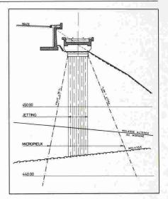
Fig. 9. – Estacade des Côtes-de-Tivoli : profil type.
