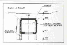
Fig. 18. – Tranchée couverte de Malley: coupe type de la partie à parois berlinoises.
