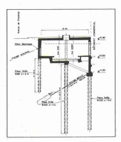
Fig. 14. - Station de Malley: coupe type.
