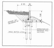
Fig. 22. – Mur de soutènement EPFL-Sorge : coupe type.
