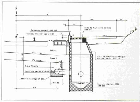
Fig. 6. - Assainissement: exemple d'un détail.
