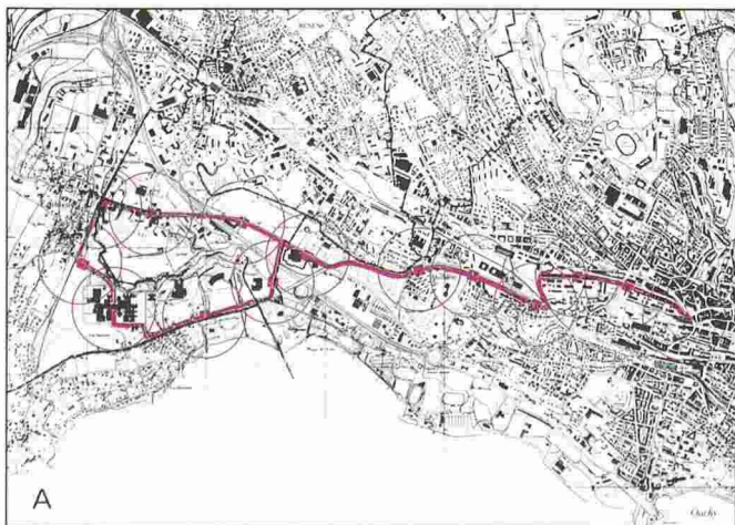
Fig. 5. - Tracé des deux solutions retenues. A: axe fort trolleybus. B: tramway (métro léger).
