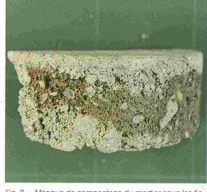
Fig. 8. – Manque de compactage du mortier sous les fissures.
