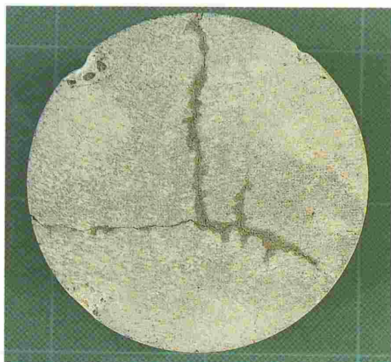
Fig. 7. - Carottage au droit de fissures.
