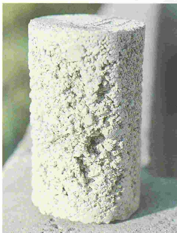
Fig. 5. - Carotte montrant la partie inférieure cavernueuse et peu résistante.
