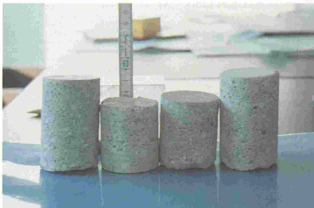
Fig. 6. - Prélèvement de carottes dans le même local. Variation d'épaisseur: 50 à 80 mm.
