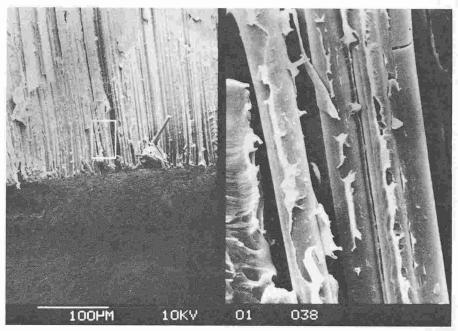
Fig. 19.— Surface de rupture et déformation plastique (outil spécial pour composites). Détail de droite: déformation plastique de la matrice.
