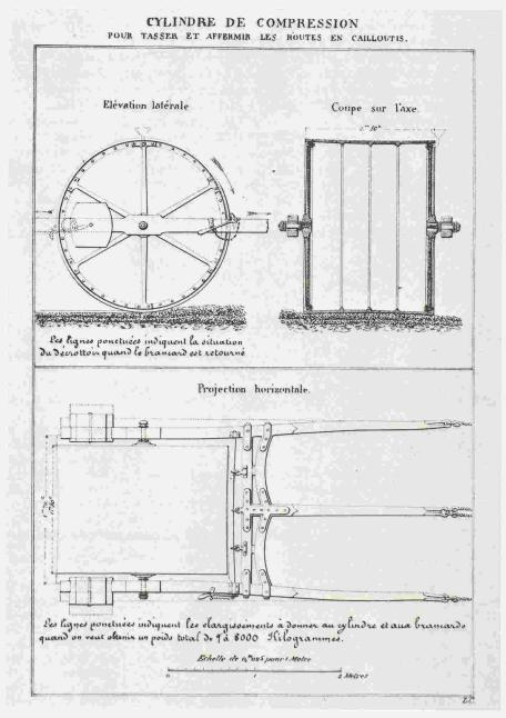
Fig. 1. – Cylindre compresseur à attelage. Système Polonceau, en fonte, d'un diamètre de 2 mètres (3700 kg), à remplir de 1200 litres d'eau. Un tel engin fut acquis par le canton de Genève en 1841. (ACV, KIX 1/13.)
