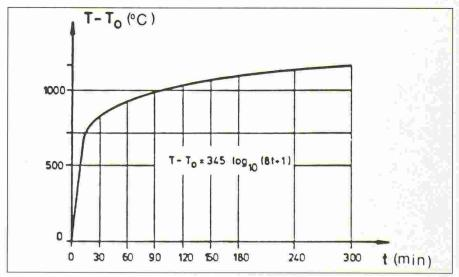
Fig. 1. - Courbe normalisée de montée en température.
