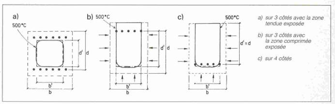
Fig. 3. - Sections réduites d'une poutre en béton armé exposées au feu.
