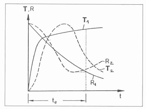
Fig. 7. - Temps équivalent te
