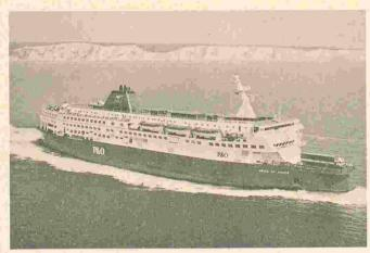
Le transbordeur Pride of Dover, en service sur la Manche, est propulsé par trois moteurs Diesel Sulzer semi-rapides à 14 cylindres, du type ZA40S. (Photo: Sulzer SA Winterthour.)
