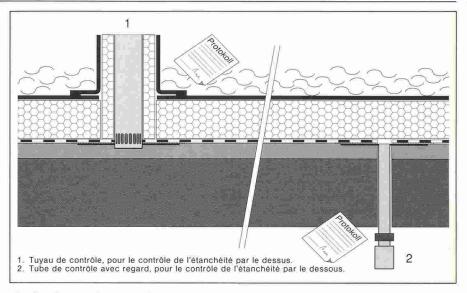
Fig. 2. – Dispositifs de contrôle pour la surveillance permanente de l'étanchéité sur les toitures plates, tels qu'ils sont réalisés actuellement sur les constructions neuves ou lors de réfections avec une nouvelle toiture chaude.
