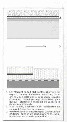
Fig. 5. – Nouvelle toiture froide sur toiture chaude existante.
