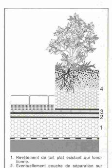
Fig. 10. - Changement d'utilisation avec renforcement de l'étanchéité.
