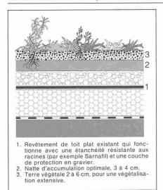
Fig. 11. – Changement d'utilisation sans renforcement de l'étanchéité.
